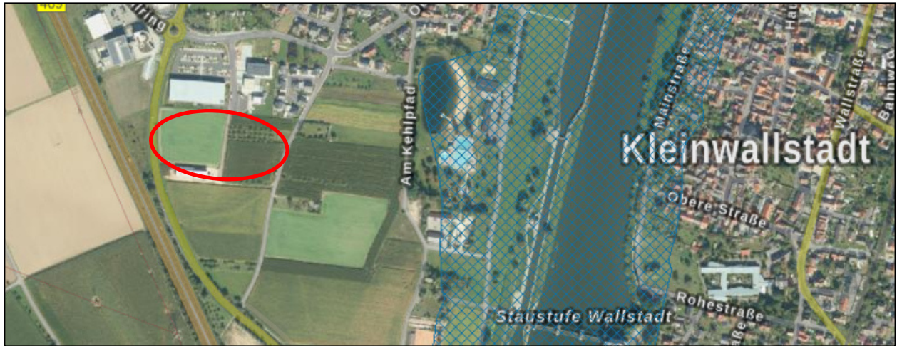
Abb. 5: Lage des Plangebietes (rot) zu gesetzlich festgesetzten Überschwemmungsgebieten (blau). (Quelle: Geoportal Bayern, Abfrage vom 13.06.2023)
